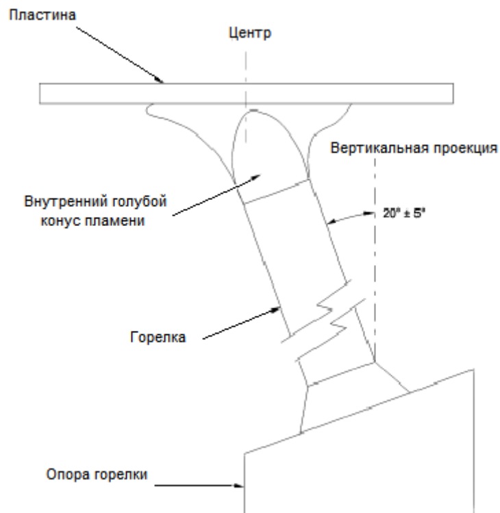
Рисунок 2 — Испытание горизонтального горения пластинчатого образца
