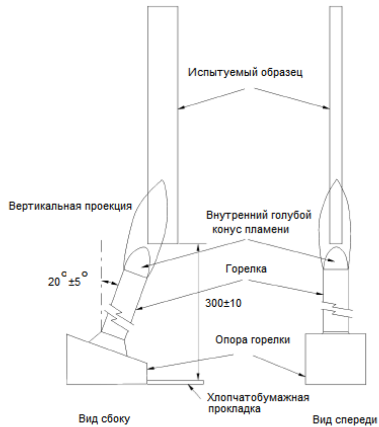
Рисунок 1 — Испытание вертикального горения для брускового испытуемого образца
